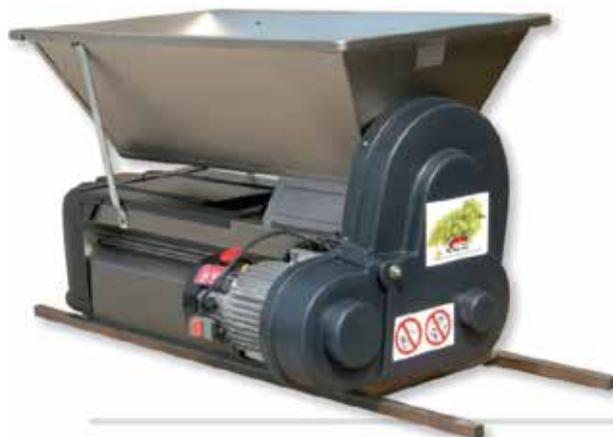
La macchina è costituita da una **tramoggia** di carico che accoglie l'uva da sottoporre a diraspatura.
