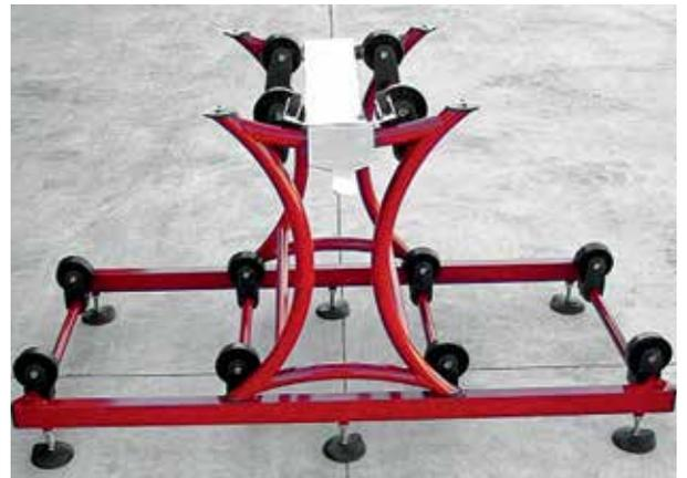
Slitta per inserimento barriques - Insert slide tool
